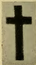
Radiographie eines Zinnkreuzes durch eine entfernte, kleine Strahlungsquelle.
